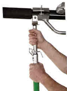
Sliber/midterakse løftes op for slibning af loft
