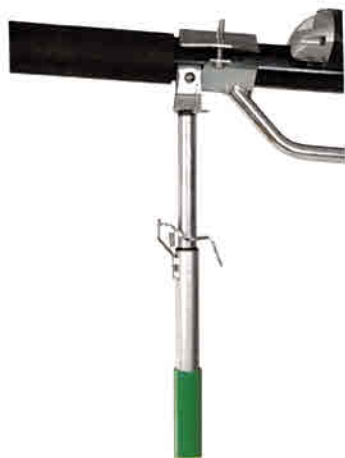
Ved sænkning af sliber aktiveres faldlåsen
